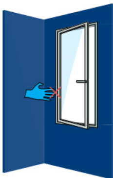
Gevaar voor letsel door bekneld raken tussen raam- of deurvleugel en kozijn.
